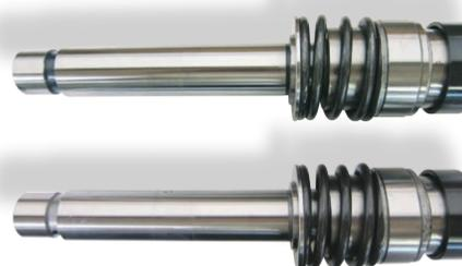
Стандартный патрон обрабатывает наиболее распространенные клапана. Дополнительные патроны доступны для очень маленьких и коротких клапанов, а также клапанов большого диаметра до 19 мм (.750").
