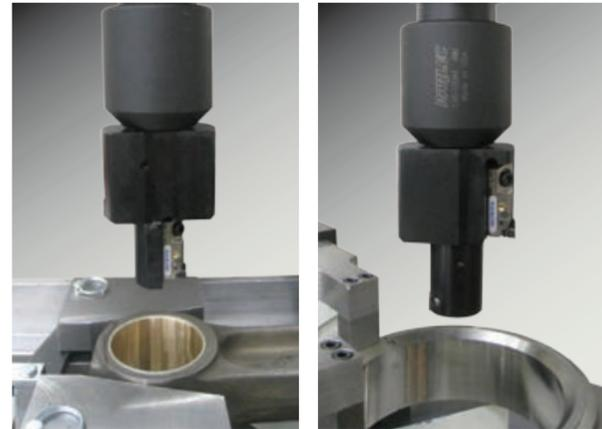
Специальные фрезерные головки двойного диаметра позволяют обработать верхнюю и нижнюю головку за один цикл. Эти фрезерные головки допускают регулировку с точностью до .005 мм.
