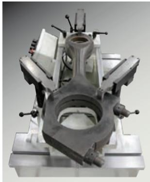
верхнюю и нижнюю головки за один цикл, обеспечивая идеальную параллельность между головками. Все шатуны можно расточить, чтобы расстояния между центрами были одинаковыми, что крайне важно для современных дизелей с высокой компрессией. Имеются высокопрочные крепления для расточки очень больших и тяжелых шатунов, применяемых в газовых компрессорах и судовых двигателях.
