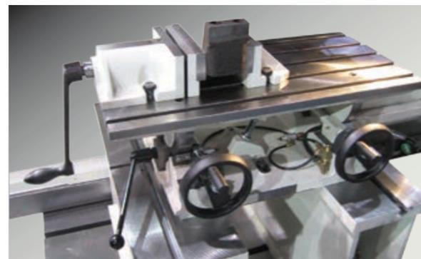
Стол с двухосевым уровнем и тисками используется для обработки крышек шатунов коренных подшипников при расточке соосных отверстий.
