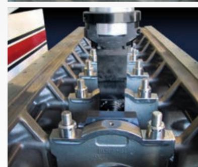
Специальные стальные корпуса коренных подшипников, используемые в высокомоощных дизелях, таких как MTU 2000, требуют высокоскоростной обработки для достижения точности и качества обрабатываемой поверхности.
