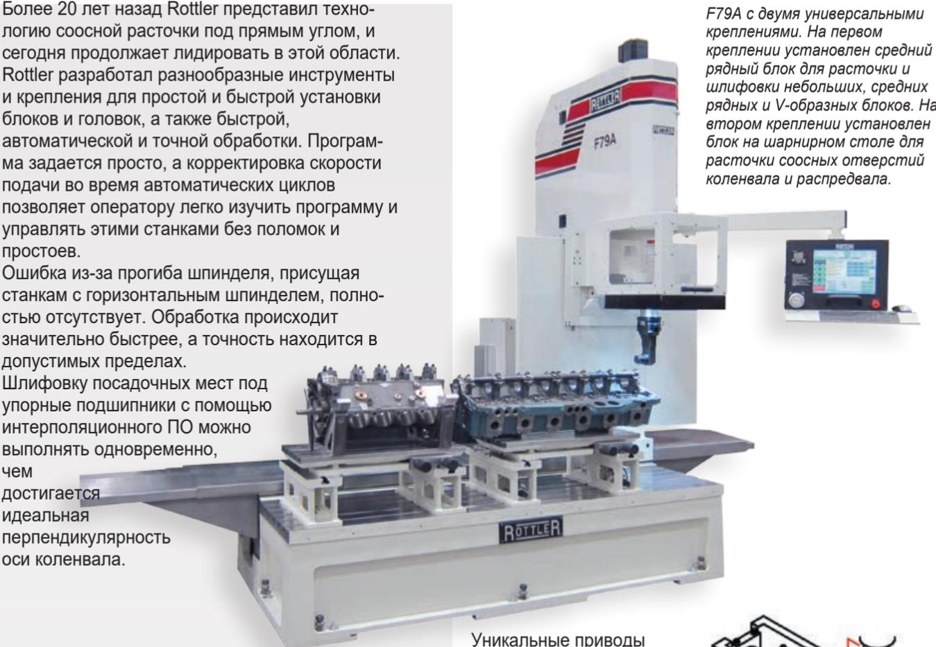
F79A с двумя универсальными креплениями. На первом креплении установлен средний рядный блок для расточки и шлифовки небольших, средних рядных и V-образных блоков. На втором креплении установлен блок на шарнирном столе для расточки соосных отверстий коленвала и распредвала.
