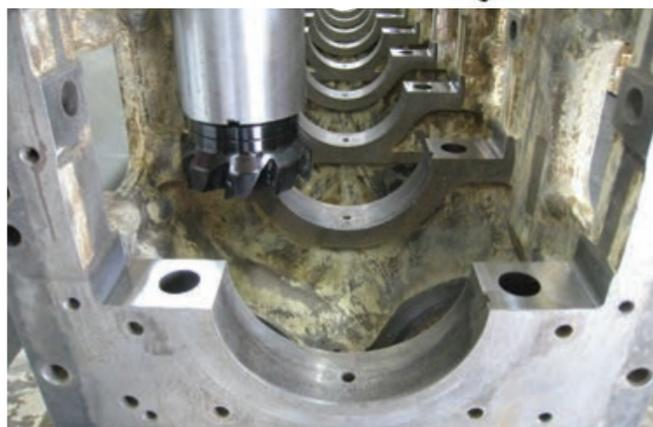
Серия F79A может обрабатывать посадочные поверхности крышек коренных подшипников в блоке, чтобы они были идеально ровными для максимального контакта с крышками коренных подшипников. При этом диаметр соосных отверстий уменьшается до стандартного диаметра.
