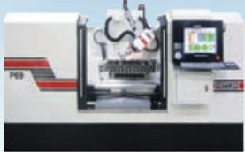
**P69AND** 5-осный станок с ЧПУ для оцифровки и обработки каналов в ГБЦ и коллекторах
