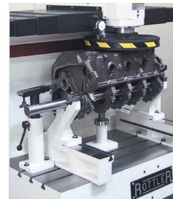
Дополнительные расстояния под крепежом и сзади него позволяют поворачивать V-образные блоки и обрабатывать с обеих сторон, не снимая блок со станка.
