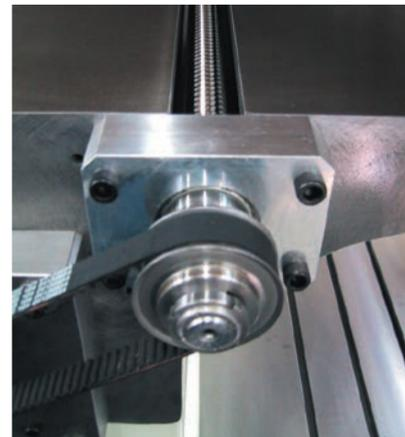
Точная шариково-винтовая пара с ременным приводом обеспечивает плавность хода.
