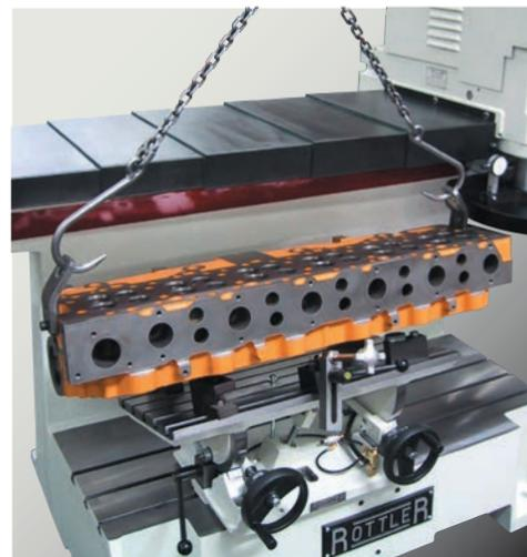
Рабочая головка перемещается в рабочее положение, а стол выдвигается на рабочей подушке для облегчения установки больших деталей, таких как ГБЦ CAT3406E.
