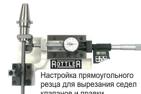
Настройка фасонных резцов точно на заданный диаметр.
