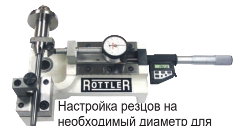
Настройка фасонных резцов точно на заданный диаметр.
