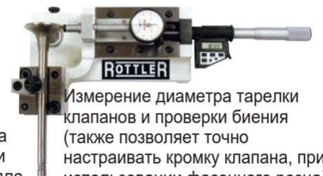
Измерение диаметра тарелки клапанов и проверки биения (также позволяет точно настраивать кромку клапана, при использовании фасонного резца).
