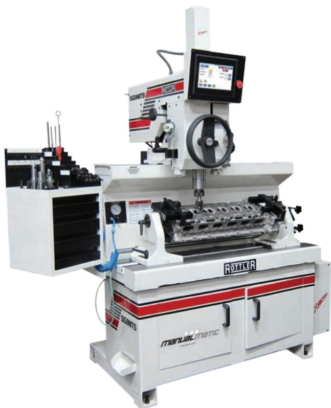
Rottler предлагает широкий выбор адаптеров для запатентованной системы Unipilot Tooling. В сочетании с огромным выбором резцов/держателей, они позволяют обрабатывать на SG9MTS седла клапанов от 0,550 до 3,25 дюйма (14 мм до 80 мм) и более.
