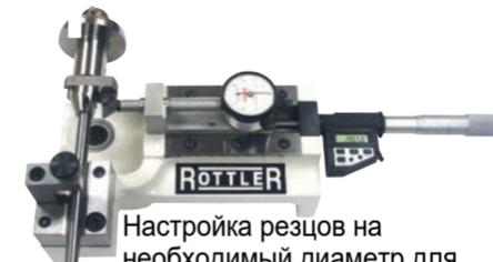
Настройка резцов на необходимый диаметр для обработки седел клапанов.
