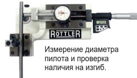
Измерение диаметра пилота и проверка наличия на изгиб.
